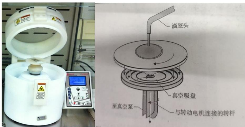
图 1 旋涂仪（左）；旋涂示意图（右）
